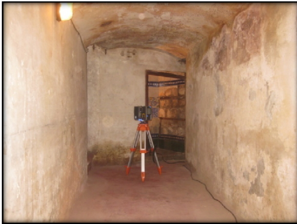
Foto 13. Màquina d'escaneig en 3D.
